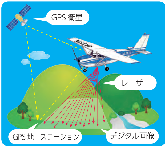
航空レーザー測量のイメージ
