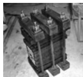
板の締め付けが甘ければ糸は染まらない
