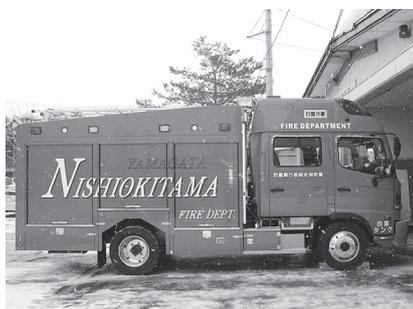
消防署白鷹分署の消防ポンプ自動車、老朽化に伴いこの度更新されました。圧縮空気泡消火装置などの装備により、有事の際には被害を最小限に食い止める近代的消火活動が可能となります。
