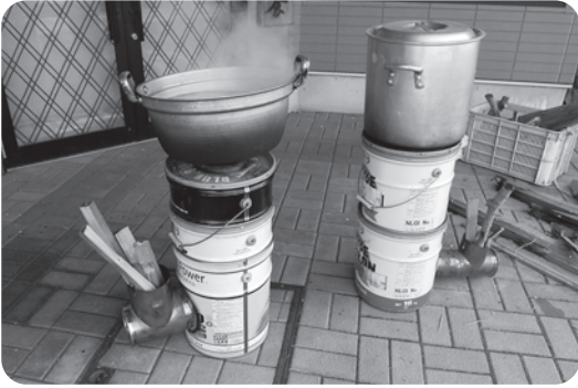
少量の木材でも十分な火力を引き出すエコロケットストーブ
